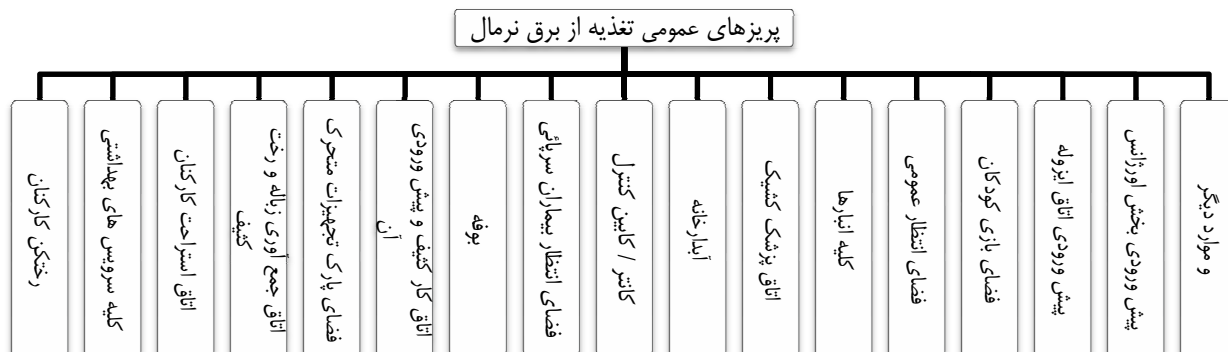
شکل ۵-۹- پریزهای عمومی تغذیه از برق نرمال
