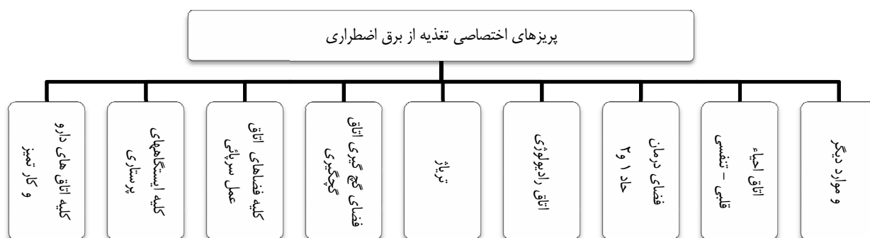
شکل ۵-۱۰- پریزهای اختصاصی تغذیه از برق اضطراری
