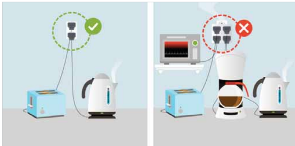
شکل ۱۲-۱۱: نمونه‌ای از بارگذاری بیش‌ازحد پریزها و استفاده نایمن از پریزها (الف)، استفاده ایمن از پریزها (ب). (۳۷)
