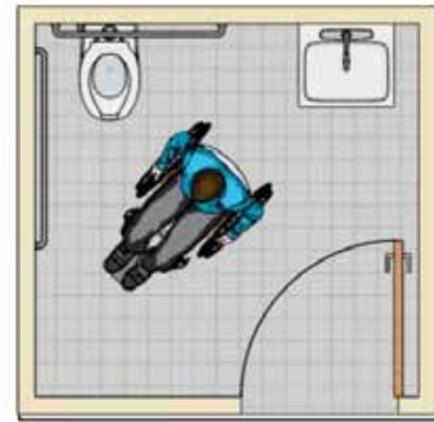
شکل ۹-۱۴: فضای مناسب برای حرکت با صندلی چرخدار و قرار گرفتن آن در کنار سرویس بهداشتی
