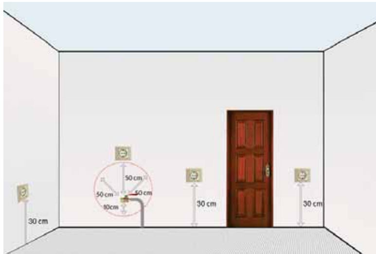
شکل ۱۲-۱۴: فاصله استاندارد پریزها از کف و شیر گاز
